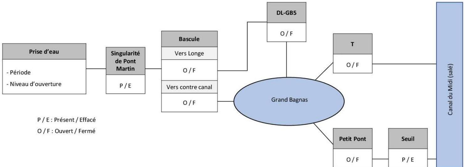
Figure 3 : schéma conceptuel de la gestion hydraulique du Grand Bagnas
