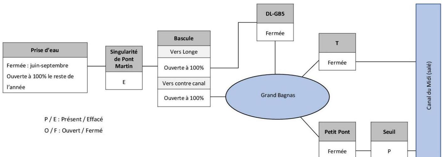
Figure 13 : schéma du scénario de gestion hydraulique provisoire (Minimaliste 2.1)
