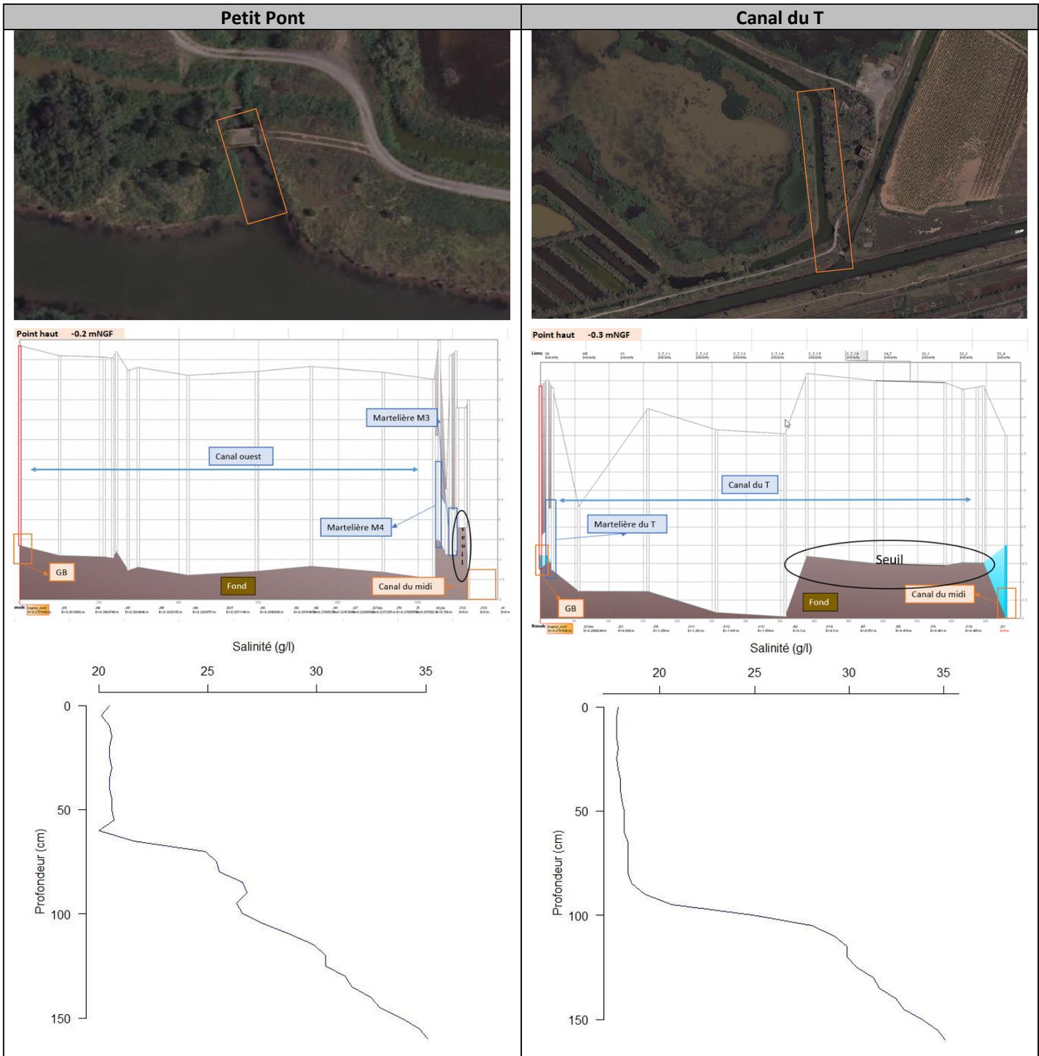
Figure 2 : localisation et représentation schématique des seuils de Petit Pont et du canal du T (Agbanrin, 2018) – Profils de salinité (ADENA, 2020b)
