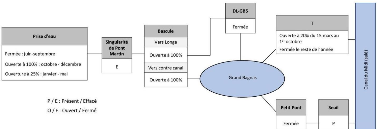
Figure 12 : schéma du scénario de gestion hydraulique retenu (Minimaliste 2.1-0.4)
