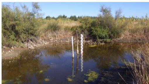
*Echelle limnimétrique installée dans une mare à côté de l'ancienne échelle et d'un piézomètre*
