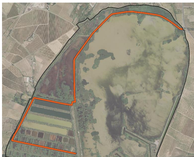
Linéaire de piste à l'intérieur duquel des tronçons d'ornières et des coulées seront remblayés
